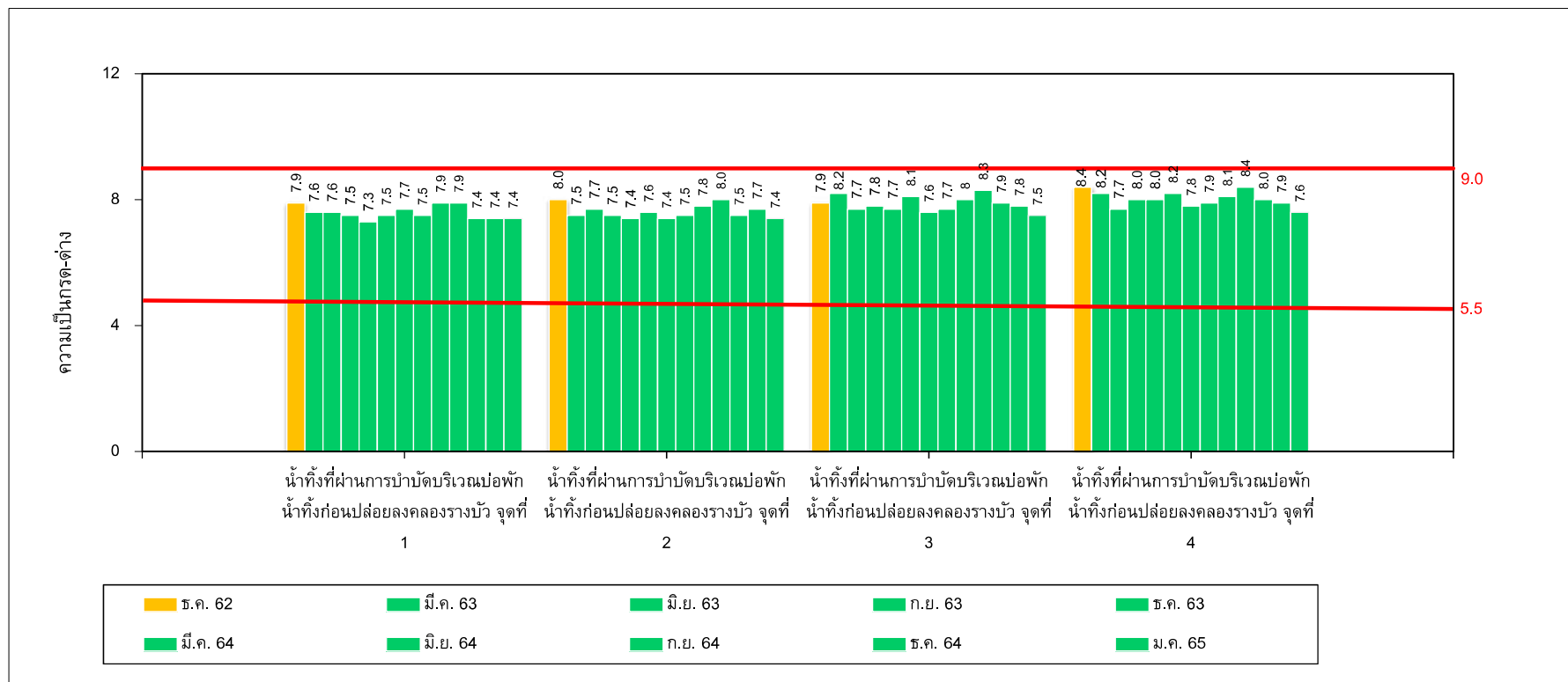
รูปที่ 3-165 เปรียบเทียบผลการตรวจวิเคราะห์ค่าความเป็นกรด-ด่าง ของคุณภาพน้ำทิ้งที่ผ่านการบำบัดเมื่อเปิดดำเนินการ บริเวณบ่อบำบัดน้ำทิ้ง (ก่อนปล่อยลงสู่คลองรางบัว)
